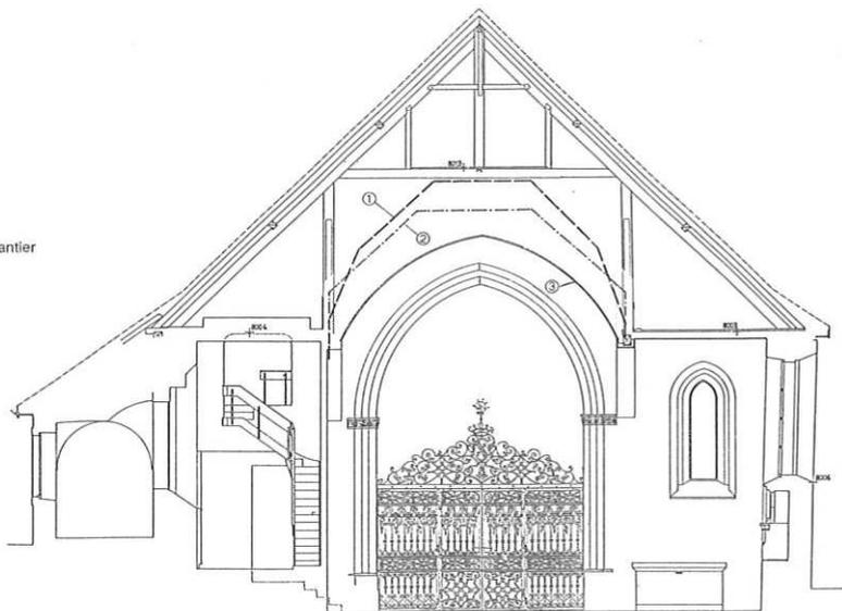
Abb. 3. Querschnitt durch die Kirche, Blick nach O, mit Angabe des über dem Triumphbogen ablesbaren Verlaufs der beiden Holzdecken und des Gipsgewölbes von 1908
